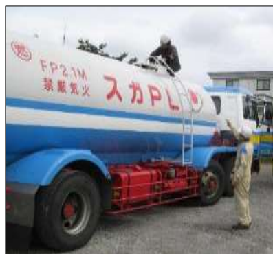
例 1) 安全弁・スリップチューブ式液面計の点検時。
