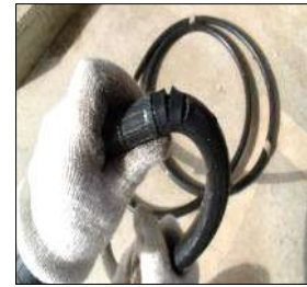
1箇所繰返し使用による割れ
