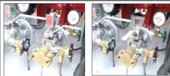
ボール弁の開閉表示 (ハンドルに開閉表示が固定されているのでハンドルを操作することで開閉が自動的に表示される。)
