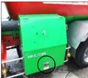
操作箱のロック装置
