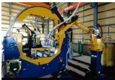
【鉄骨溶接ロボット】
