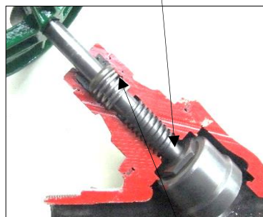
ボンネットねじの摩耗進行状況
