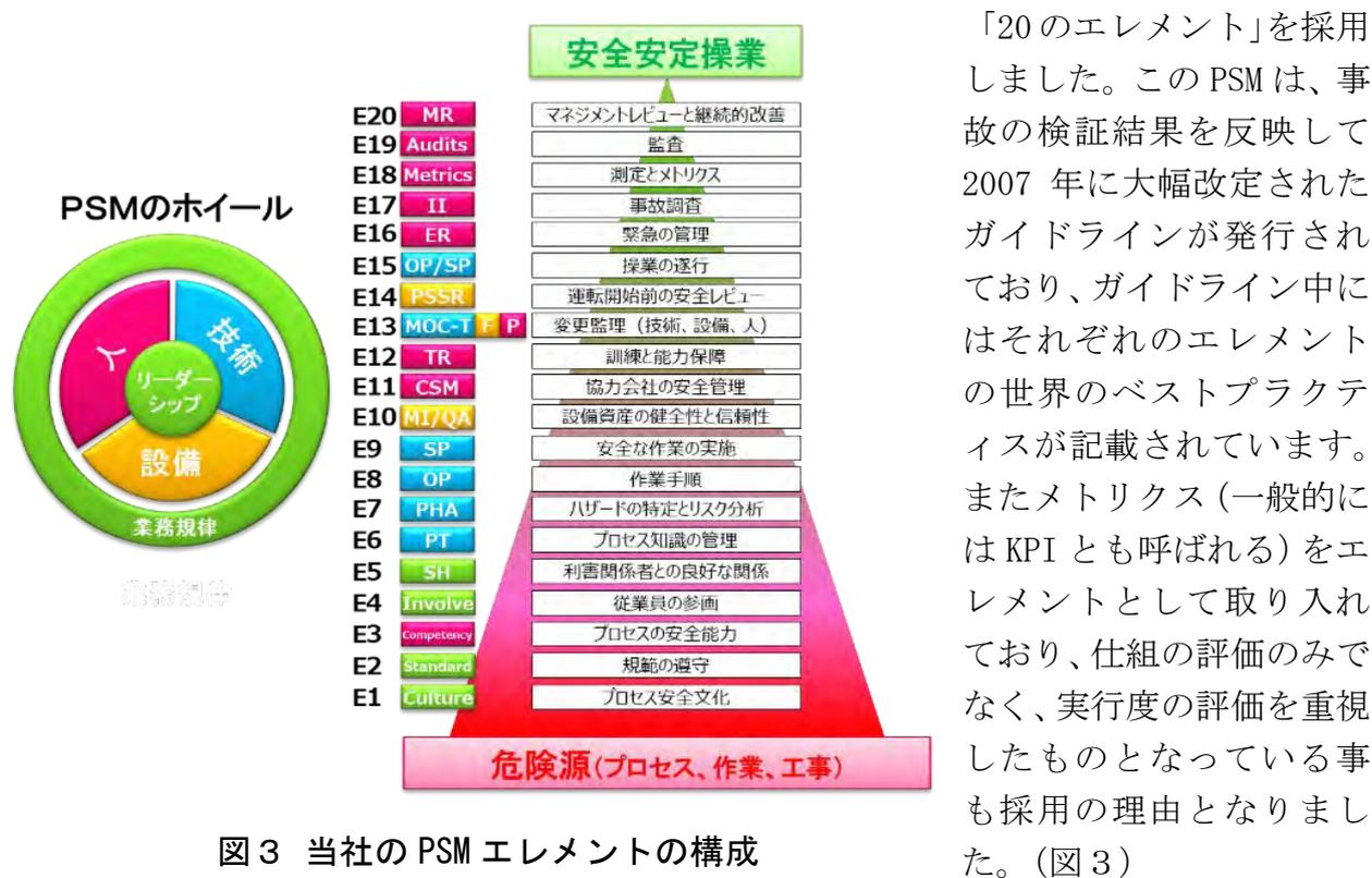
図3 当社のPSM Elementの構成
