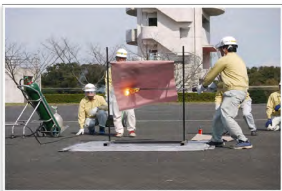
液体酸素による燃焼実験
